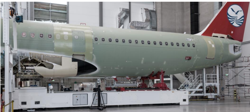
Messungen am Flugzeugrumpf mit einem Lasertracker (©Airbus)
