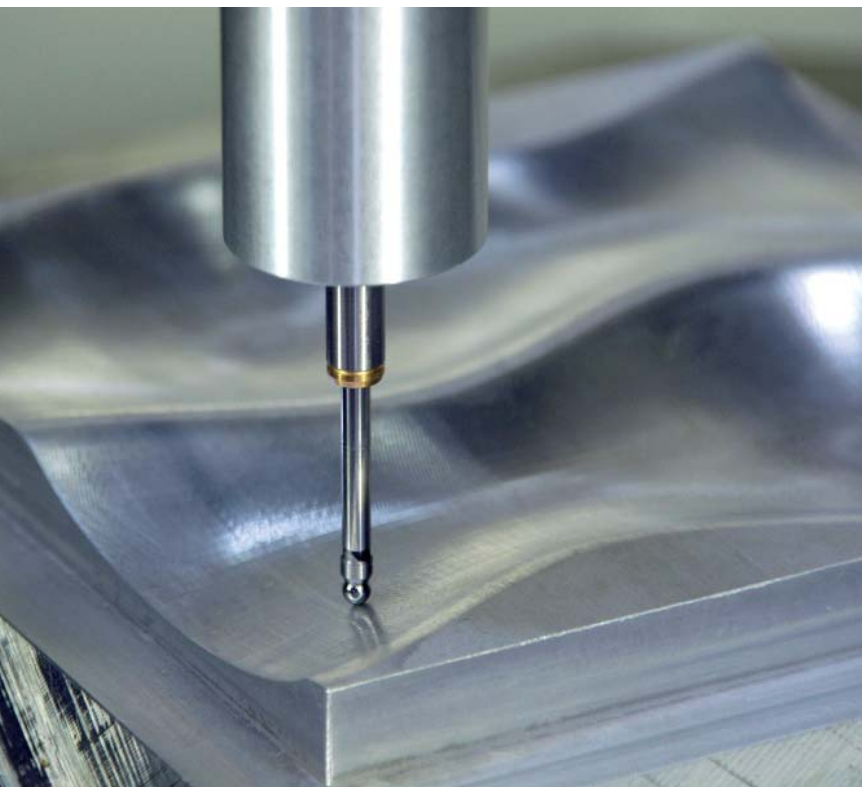
Taktiler, scannendes Messsystem integriert in Werkzeugmaschine
